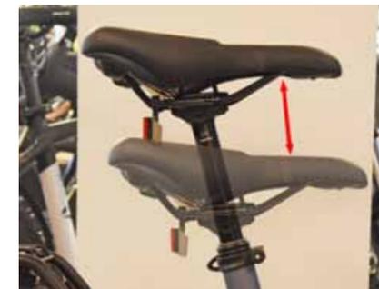
Wofür ist das gut? Wenn die Sattelhöhe ideal auf die Körpergröße eingestellt ist, kommt man nur mit den Zehenspitzen auf den Boden. Beim Ampelstopp hat man dann keinen sicheren Halt unter den Füßen. Mit der Liftsattelstütze kann beim Ampelstopp bequem der Sattel nach unten gefahren werden, so dass man mit beiden Füßen fest am Boden steht. Nach dem Losfahren, wird dann die Sattelstütze per Knopfdruck wieder hochgefahren.
